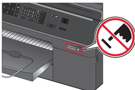
**警告—可能的损坏：**从存储设备进行打印、读取或写入时，切勿触摸区域中所示的任何开放式连接器、存储设备或打印机。可能会发生数据丢失。
