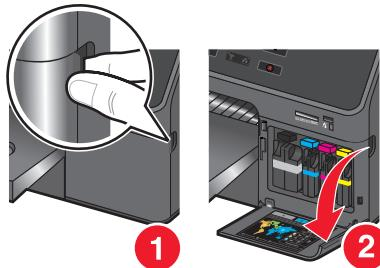
**警告—可能的损坏:** 打开打印墨盒保护门时确保不要超过 90 度,以免门体断裂。
