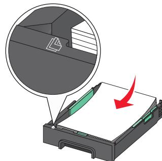
5 调整纸张导轨, 使其紧靠纸张左侧、右侧和底部边缘。
