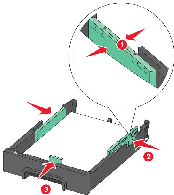
**注意:** 确认纸张低于进纸匣边缘处的最大加载线。进纸匣过载可能导致卡纸。
